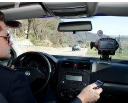
Postazione temporanea su cruscotto autovettura per rilevazione in modalità stazionaria con telecomando
